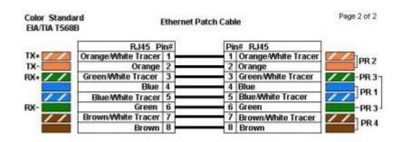
Sebelah kiri merupakan salah satu ujung kabel dan disebelah kanan merupakan ujung kabel yang lainnya. Posisi warna disesuaikan dengan posisi nomer pin untuk ditempatkan di pin RJ45 seperti dibawah ini :
