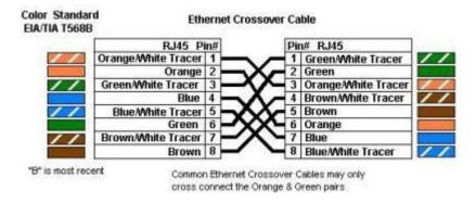
Gambar diatas ini merupakan konfigurasi yang harus Anda lakukan dalam pengkabelan. Anggap saja yang disebelah kiri merupakan salah satu ujung kabel yang dihubungkan dengan RJ45, masukan urutan warna kabel sesuai dengan nomer pin-nya. Yang disebelah kiri ini merupakan susunan Standard. Sedangkan yang disebelah kanan merupakan ujung kabel yang satunya, dan masukkan urutan warna kabel juga sesuai dengan nomer pin-nya. Konfigurasi disebelah kanan ini merupakan Cross Over.
