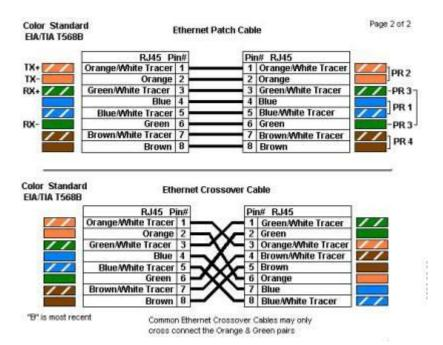
Tetapi untuk Crossover tidak pernah lagi dipakai kalau kita memakai switch hub, karena switch hub sekarang sudah otomatis melakukan Crossover bila yang dihubungkan antara swich hub dengan switch hub yang lainnya. Tetapi apabila kita menghubungkan 2 (dua) komputer tanpa melalui Switch hub kita harus melakukan Crosover seperti diatas. Sebenarnya pin#4, 5, 6, 8 tidak dipakai, jadi hubungan crosover bisa dilakukan seperti gambar dibawah
