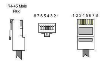
Setelah pemasangan kabel sudah sempurna tinggal dimasukkan (plug) ke port Ethernet dikomputer dan ujung kabel satunya dimasukan ke Switch Hub. Yang perlu diingat panjang kabel tidak boleh lebih dari 100 meter ( kabel UTP / STP)
