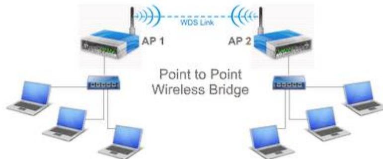
Gambar 2.2. Konfigurasi AP pada mode Wireless Bridge Point to Point
