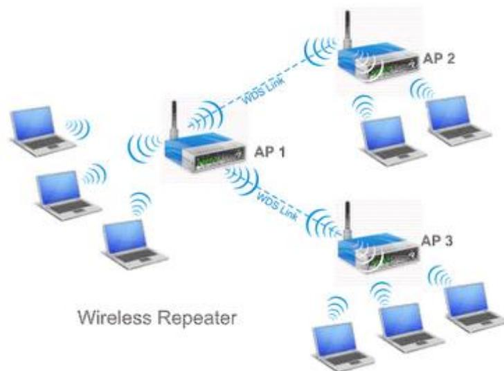
Gambar 2.4. Konfigurasi AP pada mode Wireless Repeater
