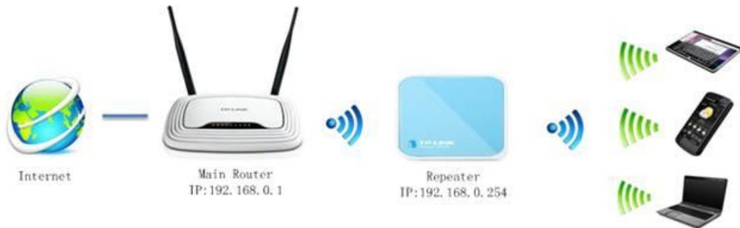
Gambar 2.8. Praktek konfigurasi AP pada mode wireless repeater
